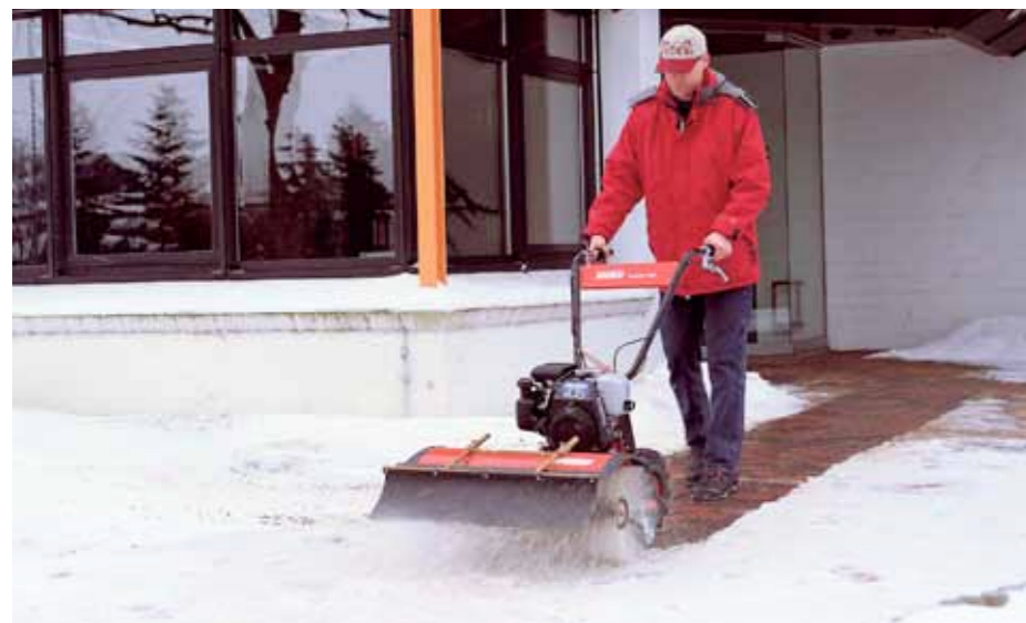
De Hako Variette 350 & de Hako Variette 500, zijn compacte, open veegmachines geschikt om in te zetten zowel in winter als zomer voor terreinverzorging. Met een veegbreedte van respectievelijk 75 cm en 100 cm, zijn deze machines als veegtoestel zeer wendbaar, gemakkelijk te bedienen en trillingsvrij te besturen.
